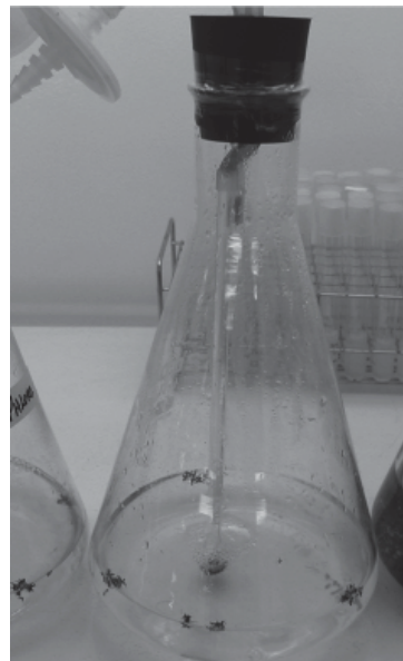
Figura 1. Biorreactor permanente empleado en los ensayos. Consta de Erlenmeyer, bomba y filtros.
